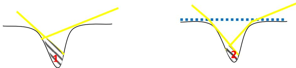
Le schéma ci-dessus représente le trajet de la lumière pour un matériau sec (gauche) et mouillé (droite). L'ombre 2 est plus petite que l'ombre 1 à cause de la réfraction.
